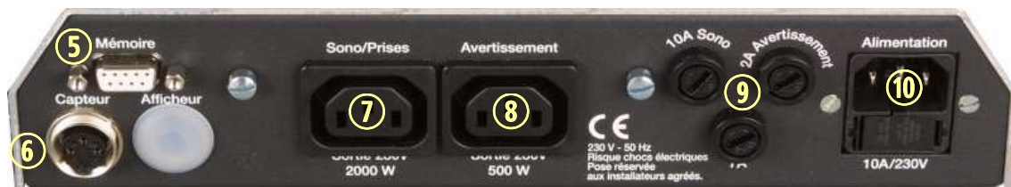
5- Prise RS232 (mémoire) 7- Prise alimentation sonorisation 9- Fusibles de protection 6- Prise micro 8- Prise alimentation avertissement 10- Prise alimentation générale (protégée par fusible)
